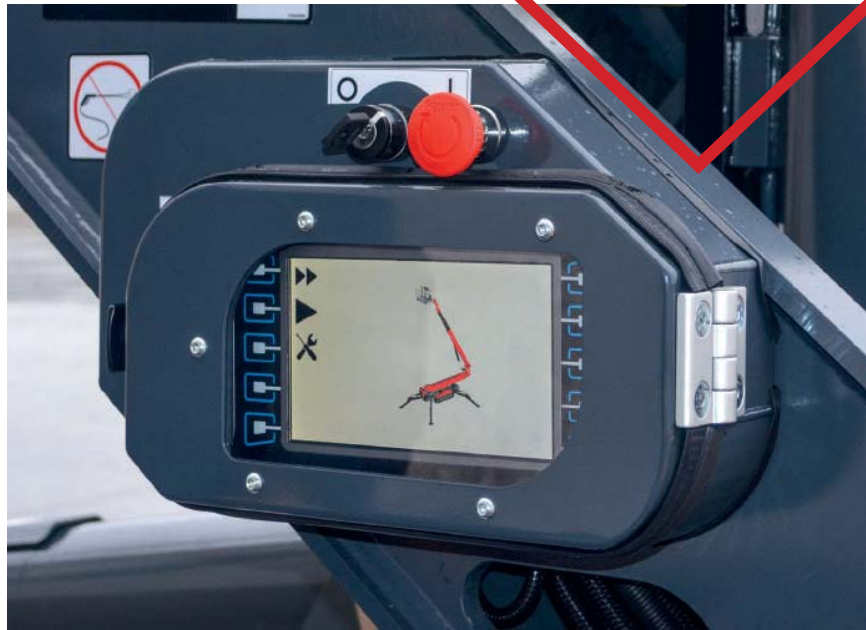
▲ Pannello smart vision LCD per i comandi a terra Pantalla "smart vision LCD" en el panel de mandos de tierra
