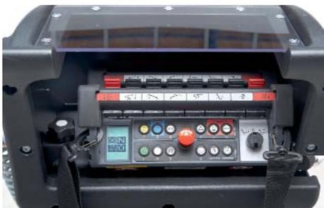
Dans la version Performance IIIS, la télécommande permet aux opérateurs d'effectuer de façon simple et pratique des opérations telles que l'auto-stabilisation, les mouvements des bras et la translation. L'écran, avec ses icônes claires et intuitives, donnent à l'opérateur des informations utiles.
