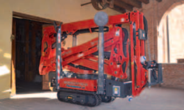
Hinowa hat als erster Hersteller den Lithium-Antrieb in sein Programm aufgenommen. Die neue Lightlift 15.70 verfügt zudem über eine Korblast von 230 Kilogramm
