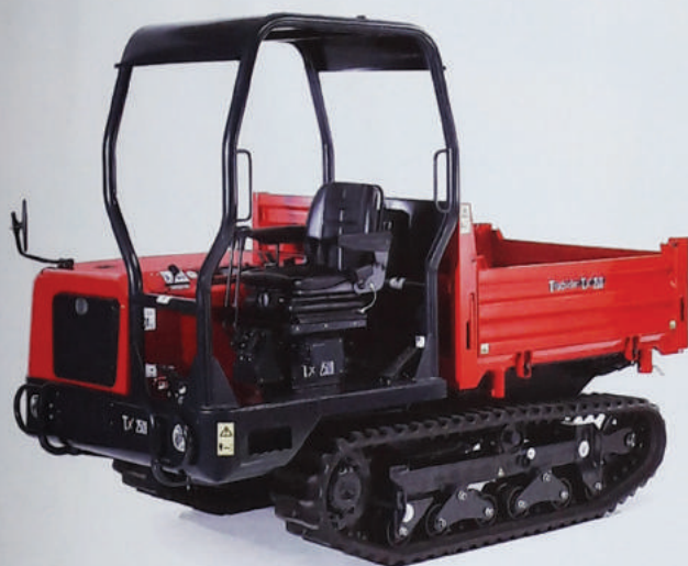
Oben: Der TX2500 ist ein kompaktes Raupenfahrzeug von Hinowa. Der Mechanismus zum Abkippen auf drei Seiten gelingt über einen Teleskopzylinder mit Gelenk (rechts).
