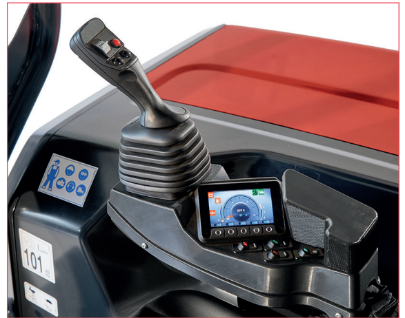
Sul joystick sono presenti tutti i comandi essenziali della macchina: gestione della pompa idraulica, gestione del cassone, acceleratore, clacson e velocità.
