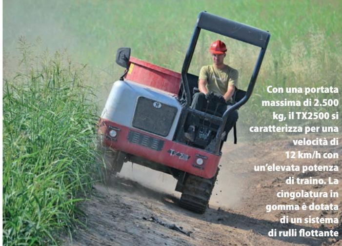
**Con una portata massima di 2.500 kg, il TX2500 si caratterizza per una velocità di 12 km/h con un'elevata potenza di traino. La cingolatura in gomma è dotata di un sistema di rulli flottante**
