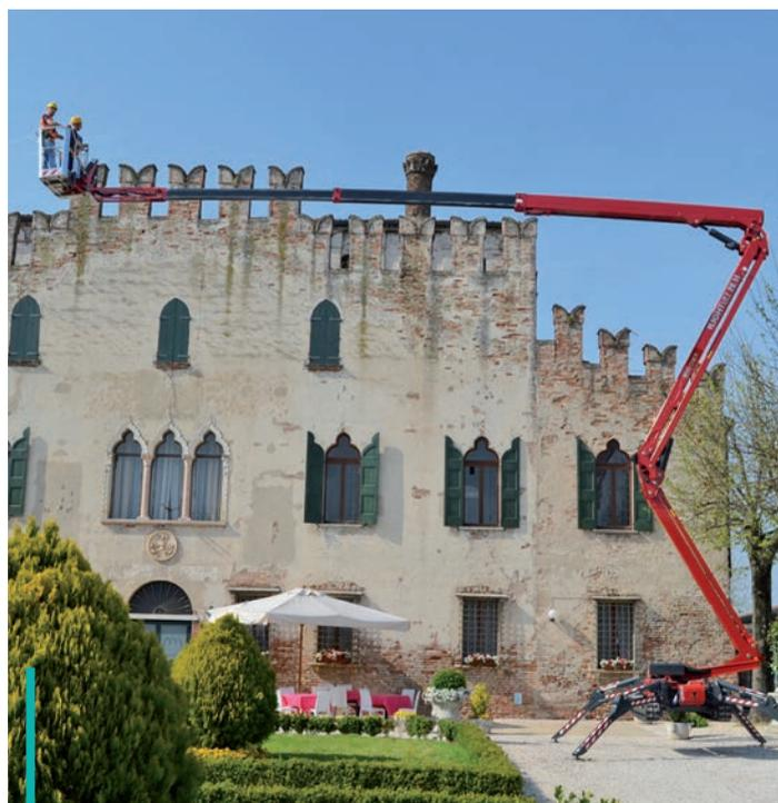
**Con 230 kg di portata utile per tutto l'arco di lavoro, che insiste su un diagramma di 25,7 m di altezza per uno sbraccio di 13,6 m con traiettoria filo muro, la nuova Lightlift 26.14 si caratterizza per estrema velocità e precisione dei movimenti e un Up&Over di 10 m per un agevole superamento degli ostacoli in quota. La stabilità è assicurata da un sottocarro allungato con carreggiata variabile da 990 a 1.490 mm. L'altezza sotto i 2 m consente un agevole passaggio attraverso le porte.**
